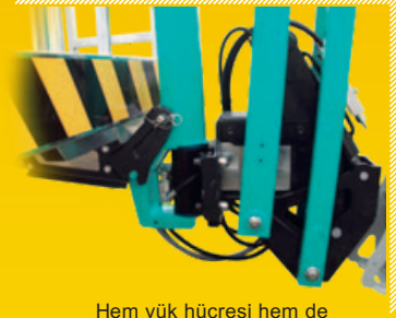
Hem yük hücresi hem de sepet dönüş sistemini barındıran bom düzeneğinin kompaktlığı.
